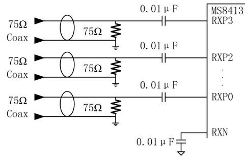
图 4.S/PDIF 多路复用器输入电路
