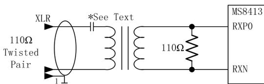
图 1.110 欧姆平衡传输（带变压器隔离）
