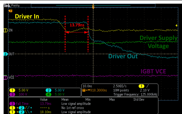
图 8-3. 用于在升压转换器中驱动 IGBT 的 UCC27524
