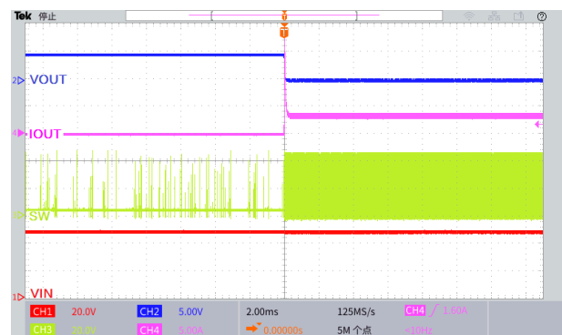
图 31.输出短路波形 ( V_{IN}=48V , V_{OUT}=5.0V )
